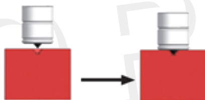
Punto fijo para piezas con muesca Fixed point for slotted parts.
